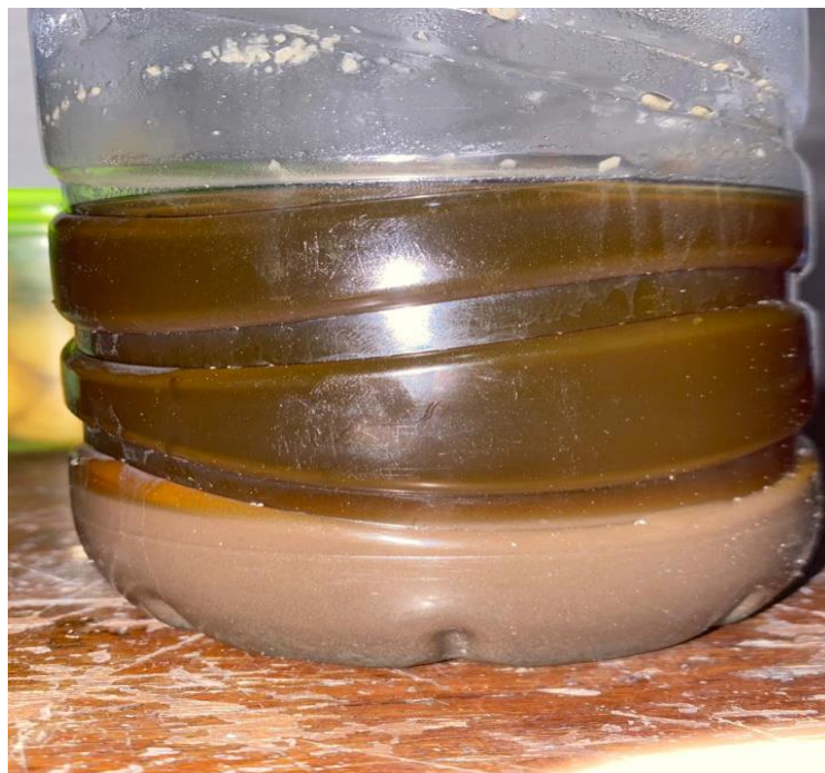
Gambar 2. Hasil Dari Pencampuran Minyak Jelantah dan Bleching yang di Diamkan Selama 24 jam
