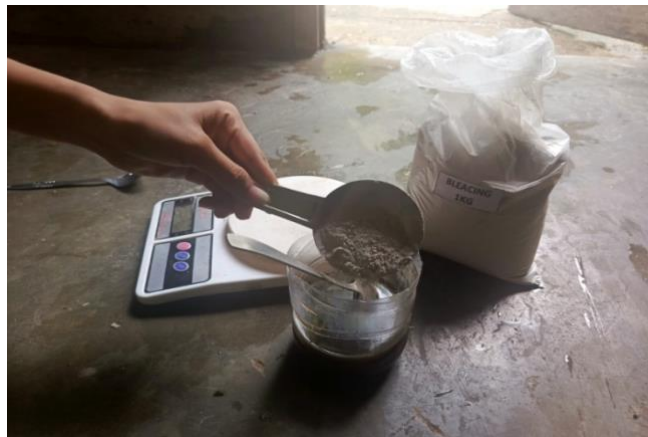
Gambar 1. Proses Penenyampuran Minyak Jelantah dengan Bleching Sebagai Adsorben dan Hasil Minyak yang Lebih Jernih
