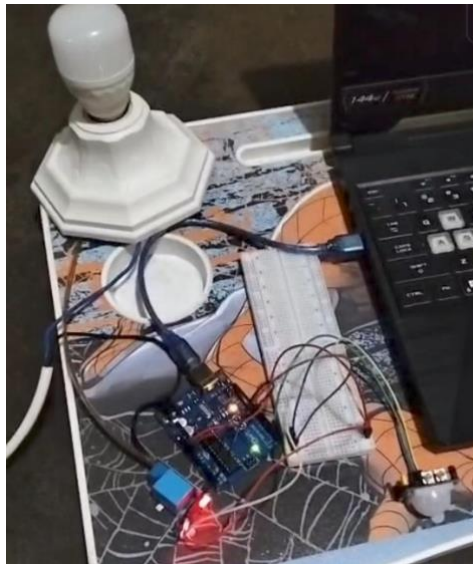
Gambar 1. Sistem Lampu Otomatis Berbasis Sensor Gerak
